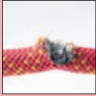
Schmelzverbrennung – Kern sichtbar –
