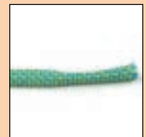
Mantelverschiebung – Kern ist kürzer –
