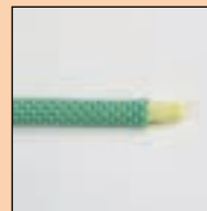
Mantelverschiebung – Mantel ist kürzer –
